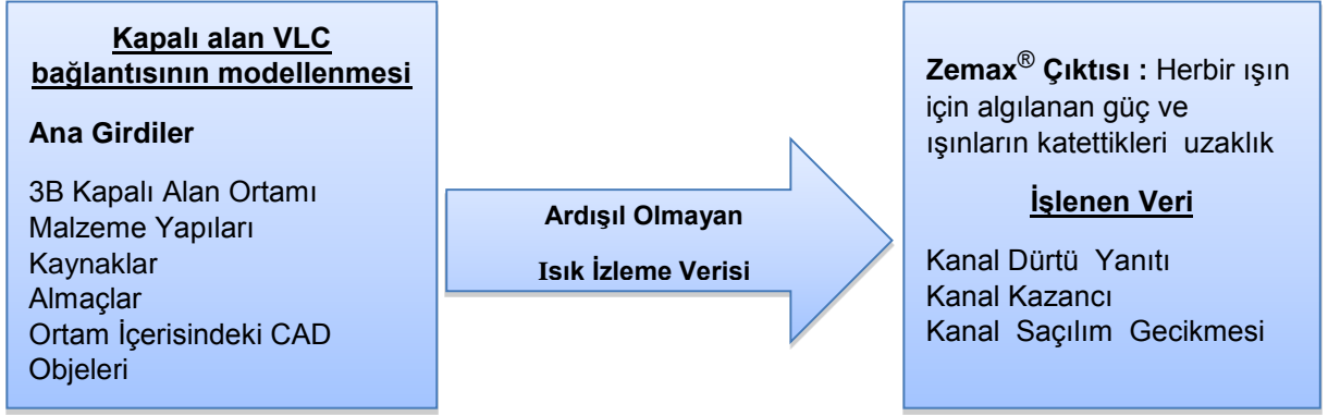
Şekil 2-8 Zemax® girdi ve çıktıları
