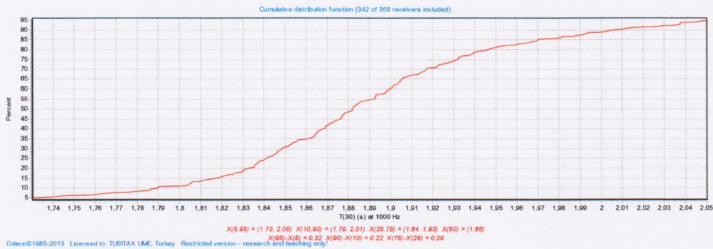
Şekil : ODEON'da S 4 kaynak aktifken RT parametresi 1000 Hz Yayılma Grafiği Kaynak: Rabia Kocaer tarafından hazırlanmıştır.
