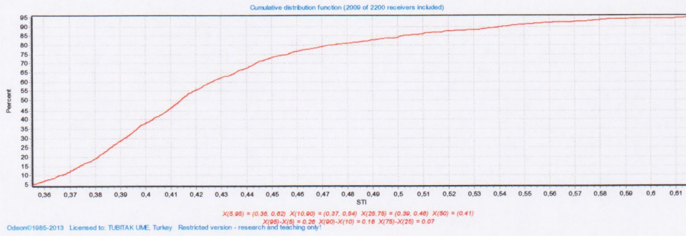
Sekil 4.50 ODEON'da S 5 (Mihrap) kaynak aktifken STI Yayılma Grafiği ve Planı Kaynak: Rabia Kocaer tarafından hazırlanmıştır.
