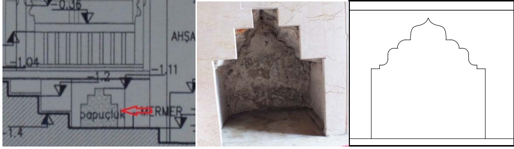
Şekil 3. 24 Muhdes Mermer Kaplama Pabuçluk ve Mermer Kaplama Arkasındaki Pabuçluk Nişinin Kesiti
