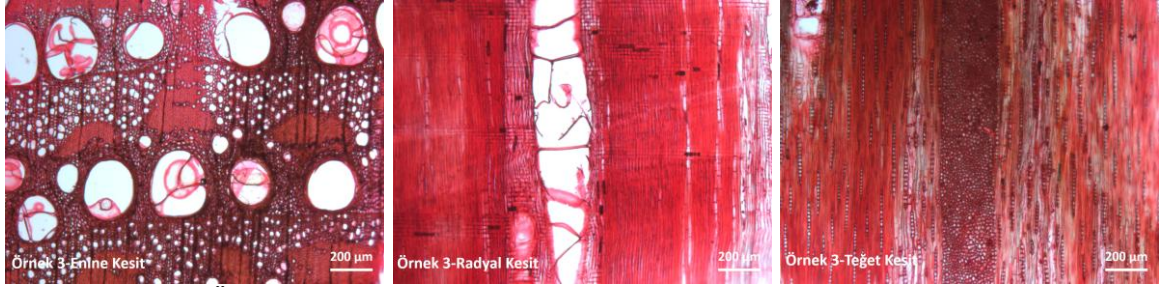
Görüntü 3.12. Örnek 3- Enine (solda), radyal (ortada) ve teğet (sağda) kesitlerin mikroskop görüntüleri
