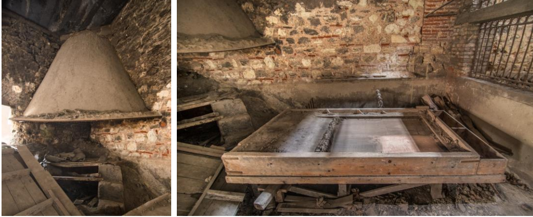
Şekil 2.38. Z01 mekanında yer alan ocak (solda) ve kurşun döküm masası (sağda)
