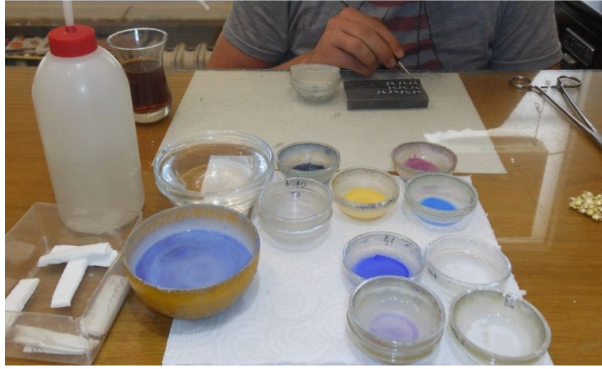
Fotođraf 7.5: Fırına girmeden önce mine boyları ile takıların üzerinin boyanması (Fot.Gülçin Anmaç)
