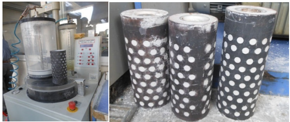
Fotoğraf 7.47: Alçılama ve vakumlama işlemi (Fot. Gülçin Anmaç, 2013)
