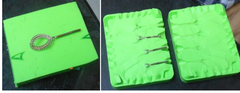
Fotoğraf 7.43: Takımın kauçuk modelinin yapılması (Fot. Gülçin Anmaç, 2013)
