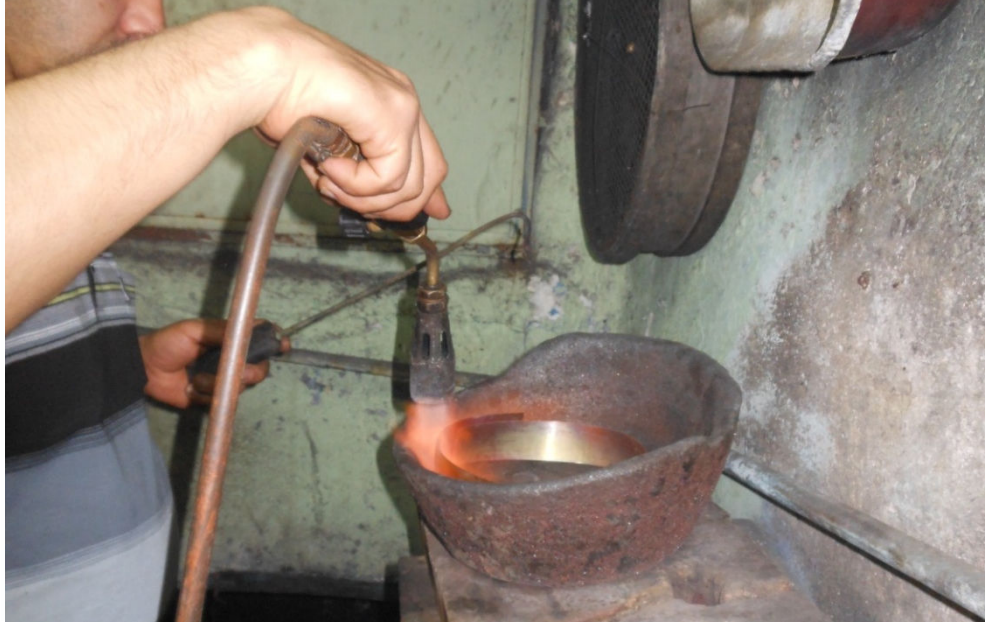
Fotoğraf 7.41: Tav makinasında, şaluma ile desenli altın plakanın ısıtılması. (Fot. Gülçin Anmaç, 2013)
