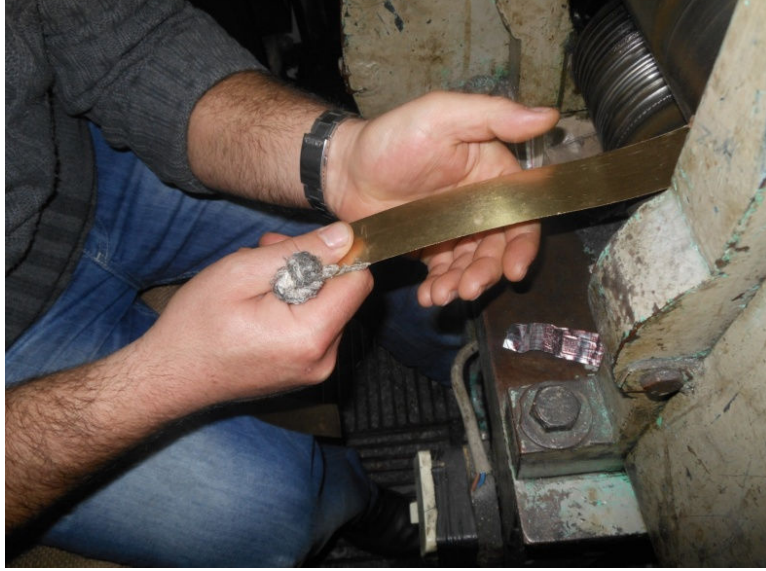
Fotoğraf 7.39: Plaka metal üzerine desen basılması (Fot. Gülçin Anmaç, 2013)
