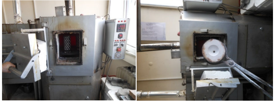
Fotoğraf 7.48: Mum indirme ve alçı pişirme işlemi (Fot. Gülçin Anmaç, 2013)
