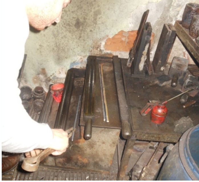
Fotoğraf 7.25: Derecelerde soğuyup katılaşılan metalin maşa ile alınması (Fot. Gülçin Anmaç, 2013)
