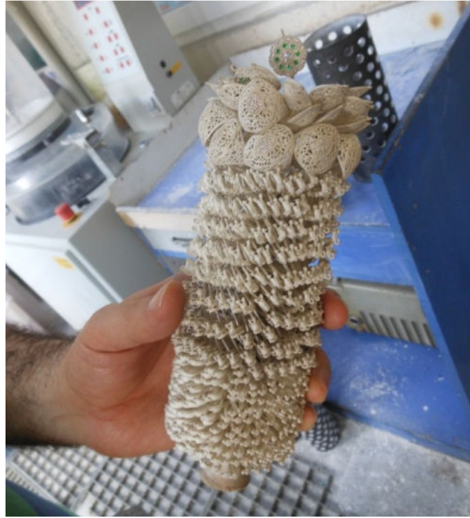
Fotoğraf 7.51: Bu metal ağaç üzerinde, her biri ayrı bir takı ve taşlı olanlar üzerinde taşları ile makinadan hazır çıkıyor. (Fot. Gülçin Anmaç, 2013)
