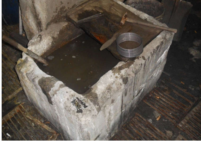
Fotoğraf 7.34: Telin ısıtıldıktan sonra suda soėutulması (Fot. Glin Anma, 2013)
