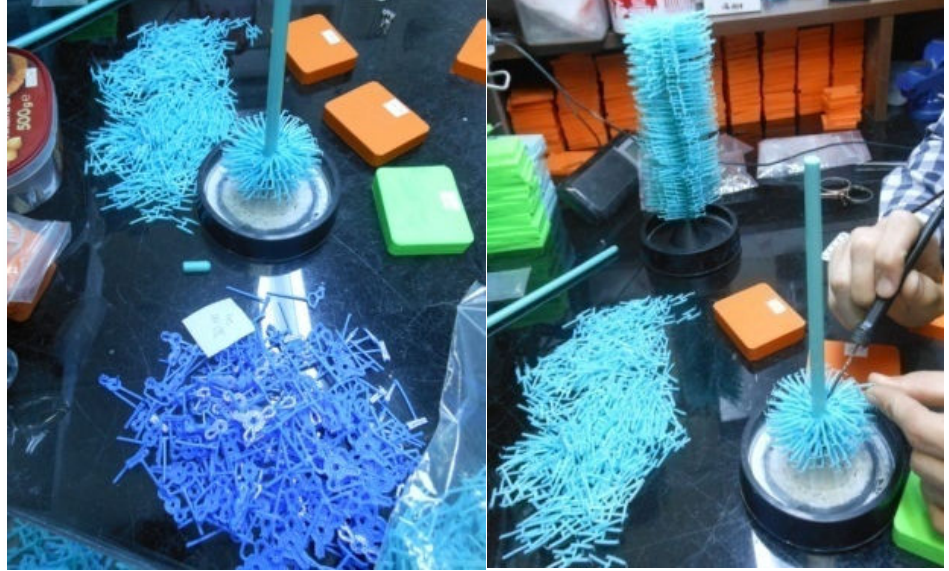
Fotoğraf 7.46: Mum ağacı hazırlanması ve mum modellerin, mum ağacı üzerine dizilmesi. (Fot. Gülçin Anmaç, 2013)
