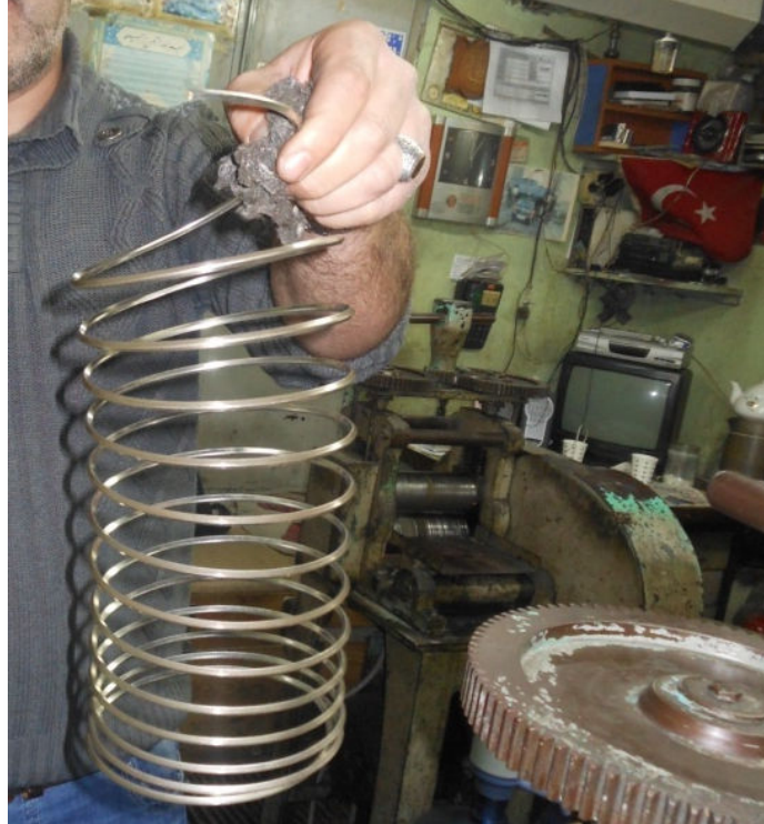
Fotoğraf 7.32: İnceldikçe uzayan ve spiral haline getirilen metal (Fot. Gülçin Anmaç, 2013)
