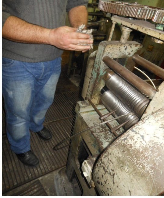
Fotoğraf 7.31: Sürtünme sırasında giderek ısınan metal, sırasıyla daha dar kapıya geçirilerek inceltilir. (Fot. Gülçin Anmaç, 2013)
