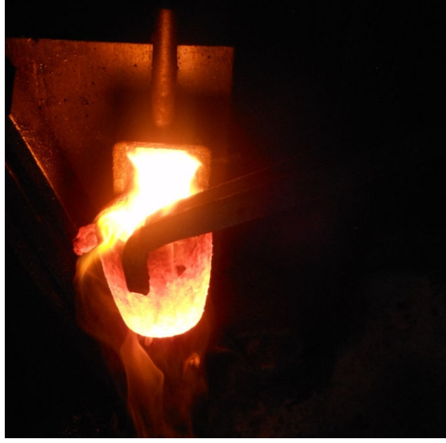
Fotoğraf 7.23: Kızgın potanın metal maşa ile ateşten alınması. (Fot. Gülçin Anmaç, 2013)
