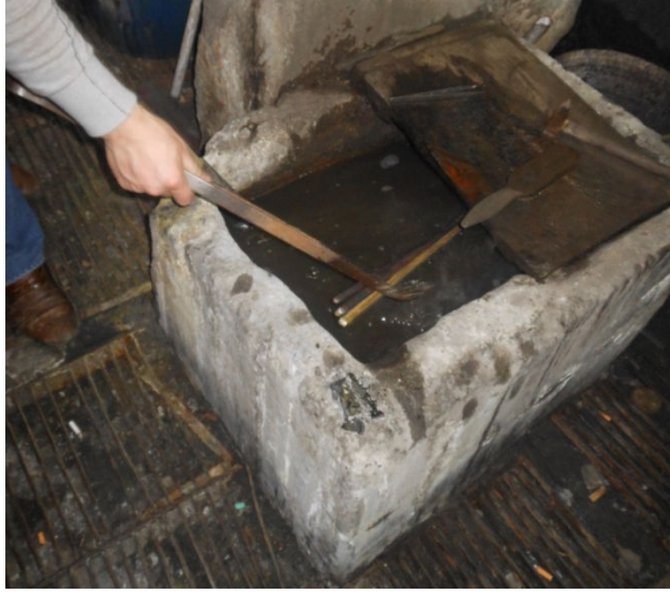
Fotoğraf 7.27: Metalin asit kovasından sonra suya alınması (Fot. Gülçin Anmaç, 2013)
