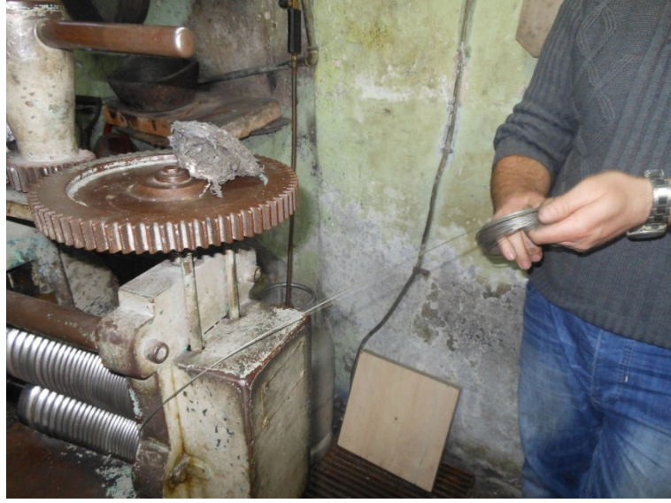
Fotoğraf 7.35 . Haddeden geçirilen metalin inceltilmesi (Fot. Gülçin Anmaç, 2013)
