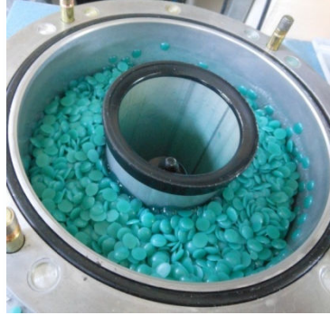
Fotoğraf 7.44: Mum, makinasında erimeden önce (Fot. Gülçin Anmaç, 2013)
