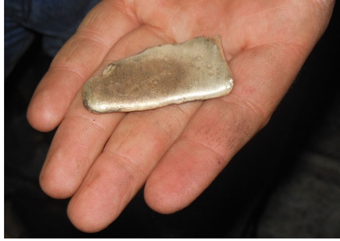
Fotoğraf 7.29: Hurda maden bu işlemler ile tek parça olur ve 'takoz' haline gelir. (Fot. Gülçin Anmaç, 2013)
