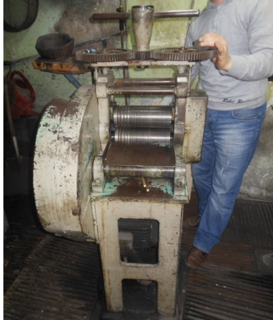
Fotoğraf 7.30: Tel çekme makinası. (Fot. Gülçin Anmaç, 2013)
