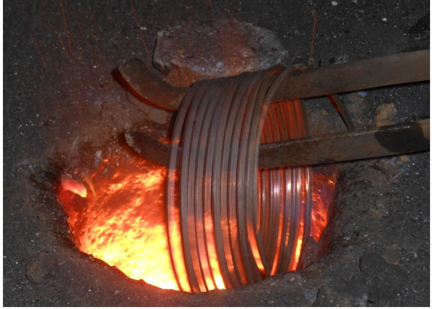
Fotoğraf 7.33: Metalin ocak içerisinde tekrar ısıtılıp tavlanaarak, yumuřatılması. (Fot. Glin Anma, 2013)
