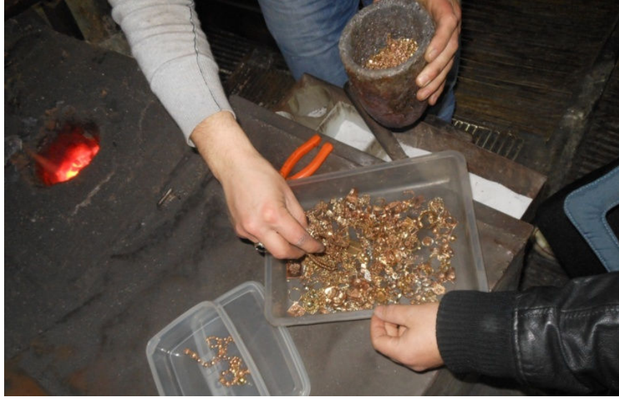
Fotoğraf 7.19: Altının eritmek üzere potaya konulması
