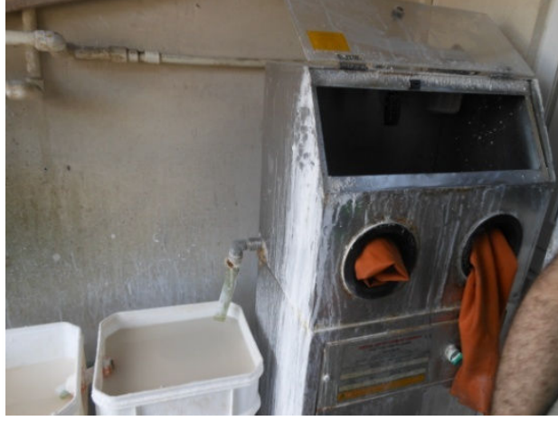
Fotoğraf 7.50: Basınçlı yıkama makinası (Fot. Gülçin Anmaç, 2013)
