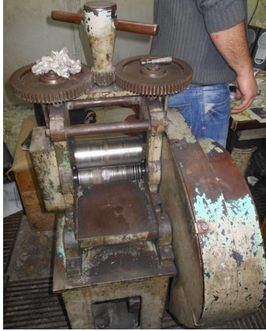
Fotoğraf 7.37: Kapıları dar, tel çekme makinası (Fot. Gülçin Anmaç, 2013)
