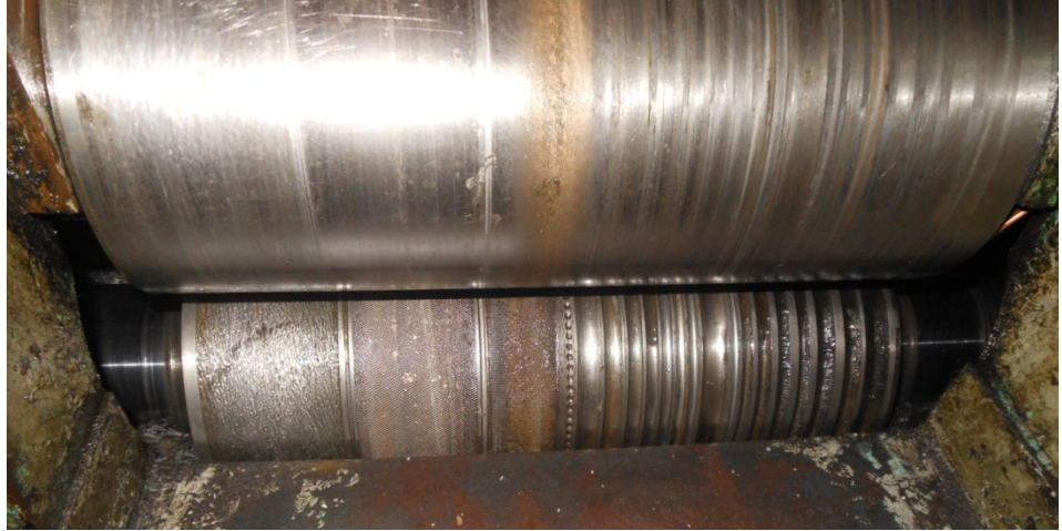
Fotoğraf 7.40: Metal plaka üzerine, rulo üzerinde olan desenler basılır. (Fot. Gülçin Anmaç, 2013)
