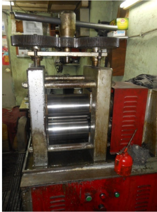
Fotoğraf 7.38: Tel astar makinası (Fot. Gülçin Anmaç, 2013)
