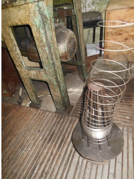
Fotoğraf 7.36: Telin firdöndüye sarılması. (Fot. Gülçin Anmaç, 2013)
