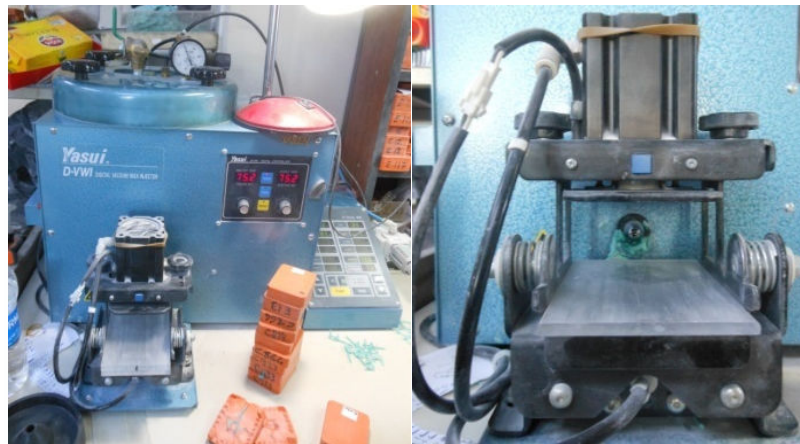
Fotoğraf 7.45: Makina ve mum doldurulmuş kauçuk kalıplar (Fot. Gülçin Anmaç, 2013)
