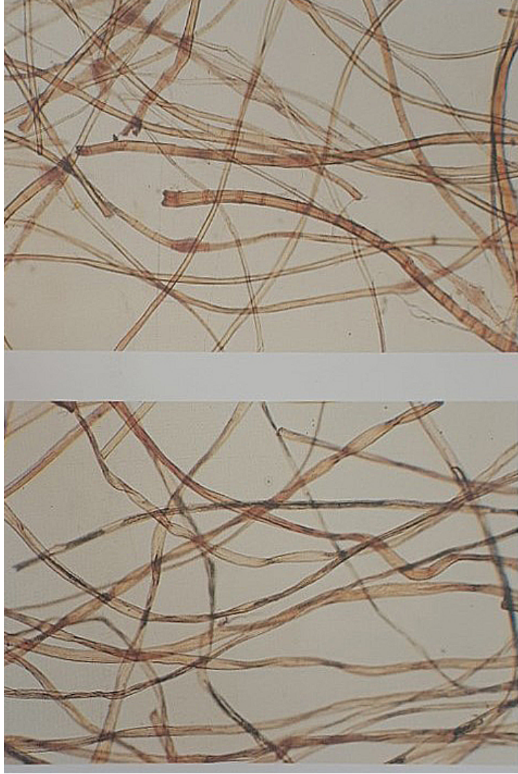
Resim E.1 Yukarıda; keten, aşağıda; pamuk liflerinin mikroskobik görünümü (Scicolone 2004 185)
