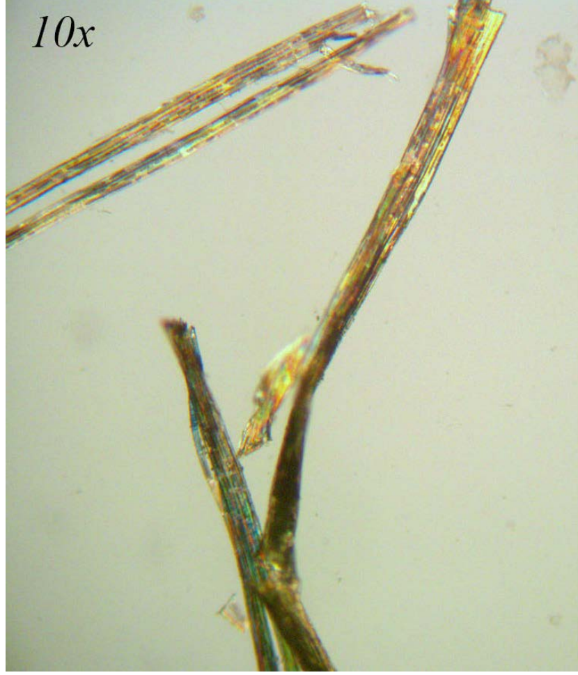
Resim 4.60 Çengelköy İskelesi ; polarize ışık mikroskobu, tuval lifleri detay görünümü. (Numune No:3; PLM 10x; RI: 1.662).
