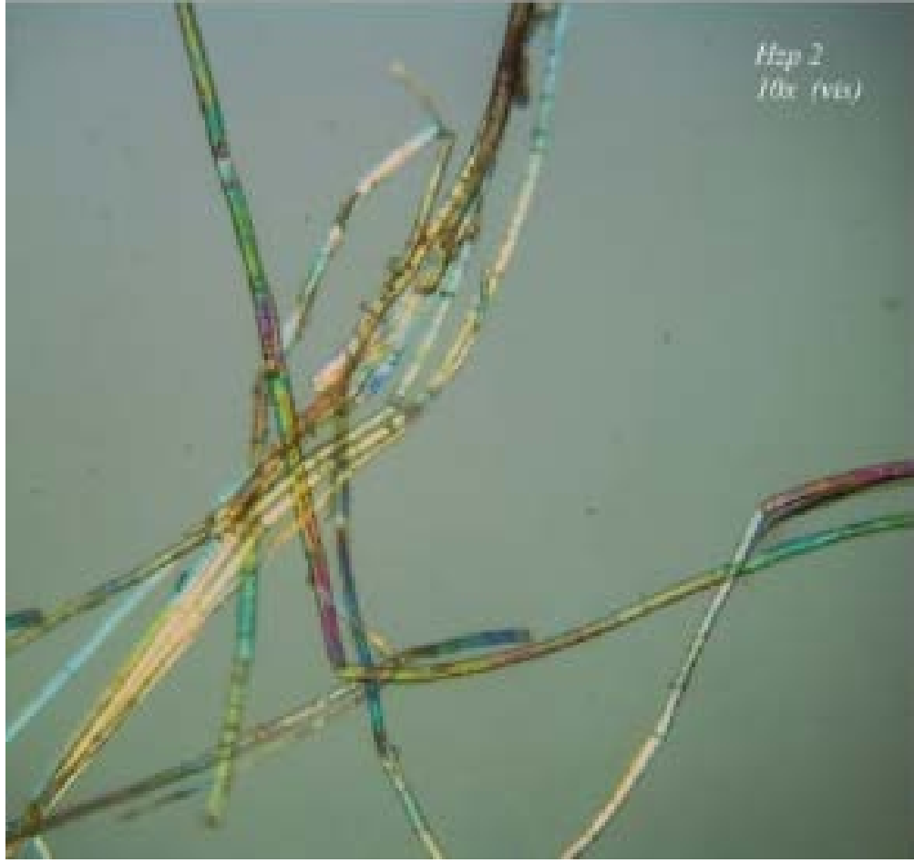
Resim 4.26 Ayasofya Camii Hünkar Mahfili ; polarize ışık mikroskobu, tuval lifleri detay görünümü.(Numune No:2; PLM 10x; RI:1,662).
