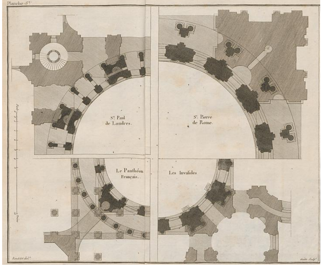
Şekil 6.22. Dört yapının kubbe strüktürlerinin ölçekli mukayesesi. Sol üstten saat yönünde: 1. Sant Paul, Londra 2. San Pietro, Roma 3. Sainte Geneviève 4. Les Invalides, Paris (Rondelet 1797: Planche 5) 196
