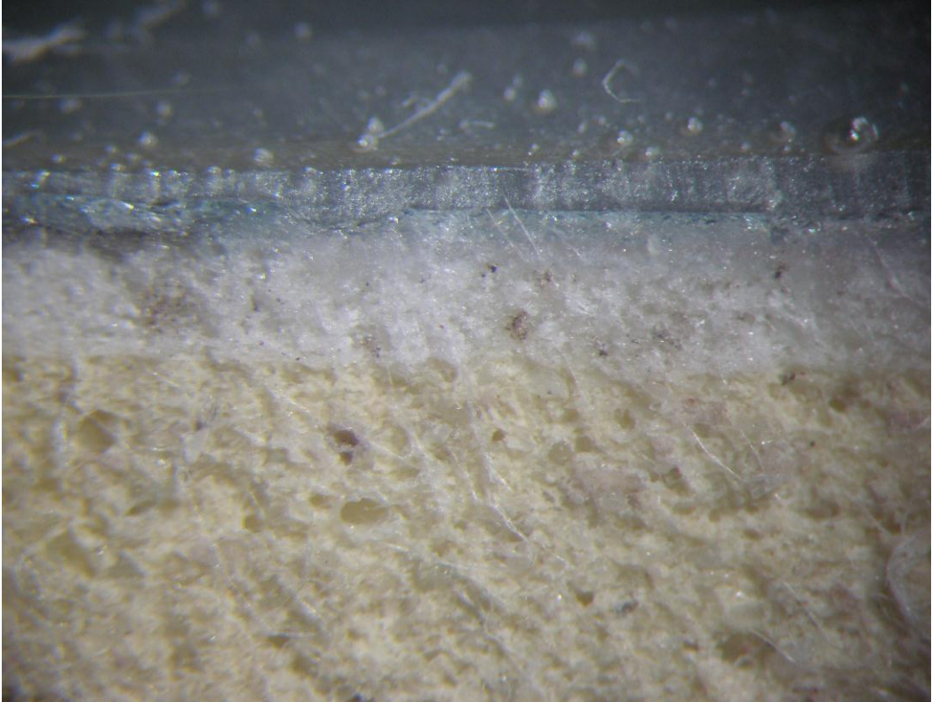
Fotoğraf 202: Sır tabakası çatlamış çini parçası
