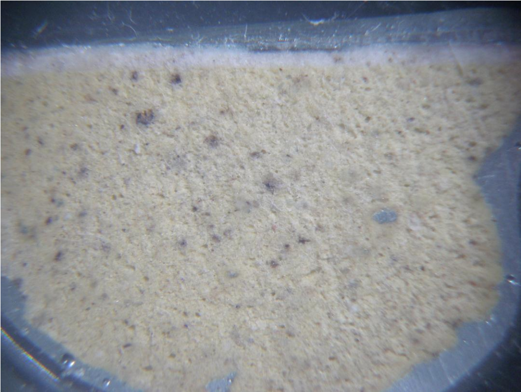
Fotoğraf 200: Sır tabakasının olduğu bölgede içten meydana gelen çatlama
