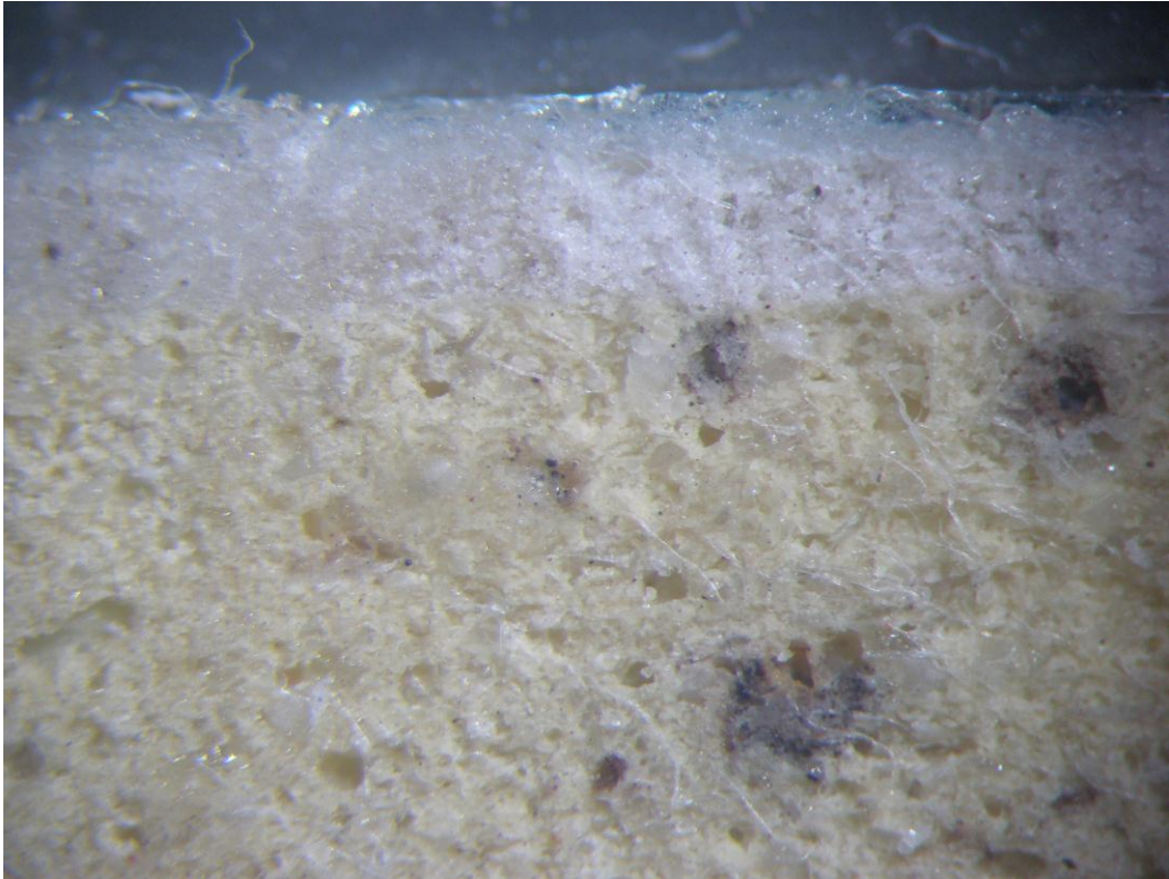
Fotoğraf 204: Hamurla sır arasında kalan beyaz astar tabakasındaki yabancı maddeler
