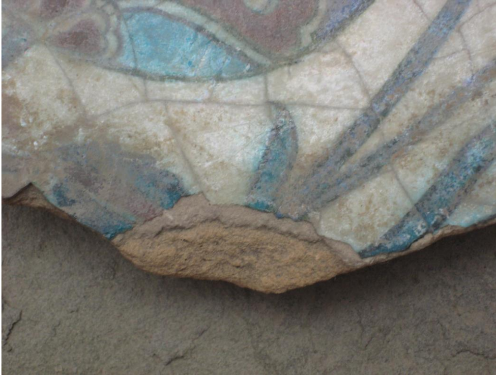
Fotoğraf 212: Müze depolarında yer alan çini parçasının sır tabakasındaki parçalanmalar
