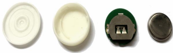
Şekil 3. B1-B2-B3 ve B4 ile gösterilen 4 adet düşük enerjili Bluetooth işaretçi (beacon)'ın iç bileşenleri ve yapısı
