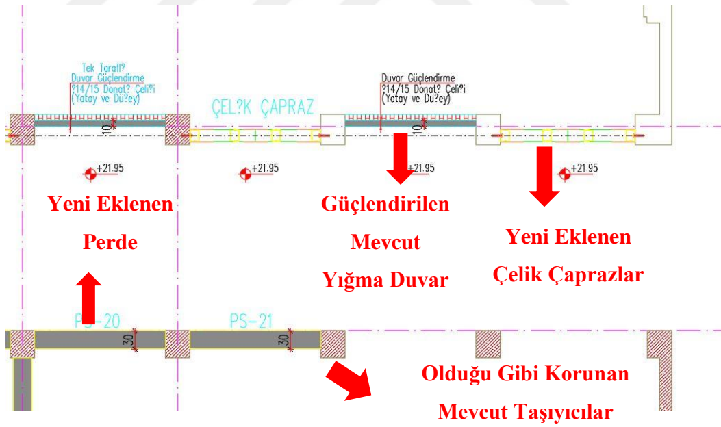
Plan 3-9 Fen-Edebiyat Fakültesi 1 Nolu Bina Güçlendirme Projesi Yeni Eklenen Perdeler (Parlar Mühendislik Müşavirlik , 2017)
