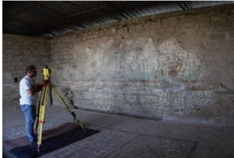
Şekil 4. 10 A.E. 36, Total Station ile atılan nokta atılması (2019) (P.K.A.)
