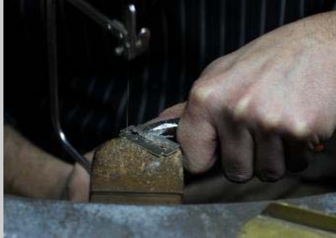
Resim 8.4.4.1. Üretim Sürecini Gösterir Örnek I: Tel Testere İle Ajur Açma İşlemi
