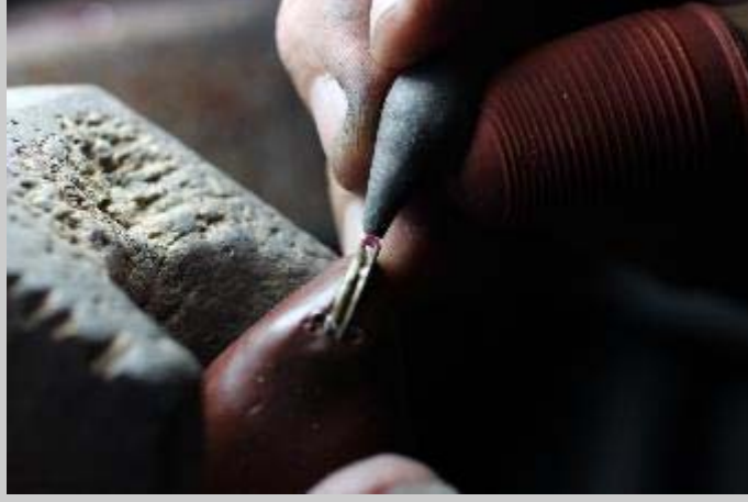
Resim 8.4.4.2. Üretim Sürecini Gösterir Örnek II: Mıhlama
