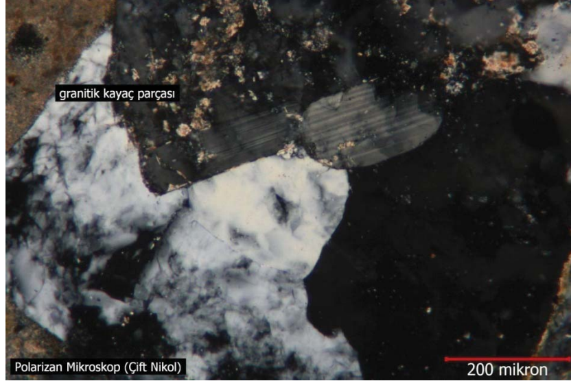
Fotoğraf 3.96. Harç 28'in polarizan mikroskop detay görünümü
