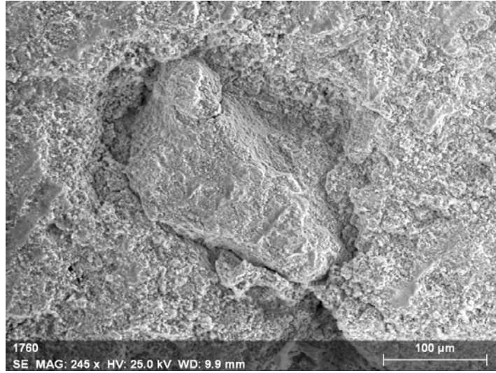
Görüntü 3.1. Harç 1'in SEM görüntüsü
