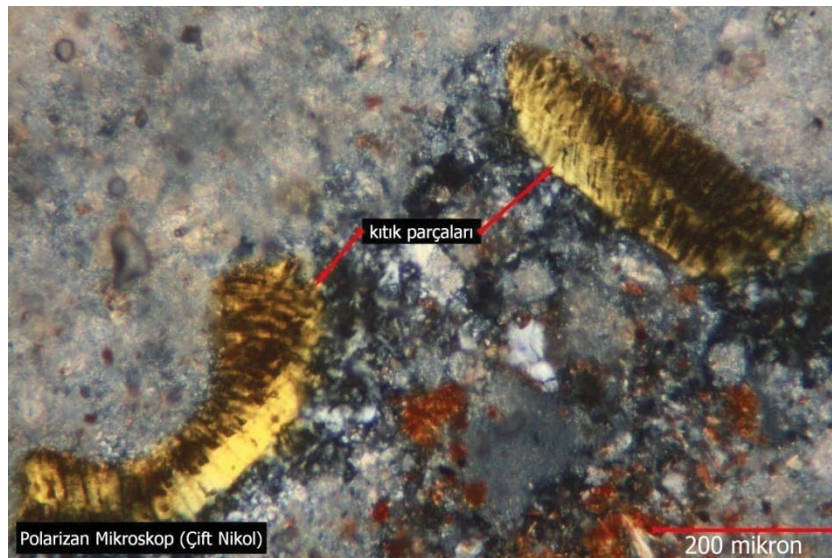
Fotoğraf 3.103. Harç 35'in polarizan mikroskop detay görünümü
