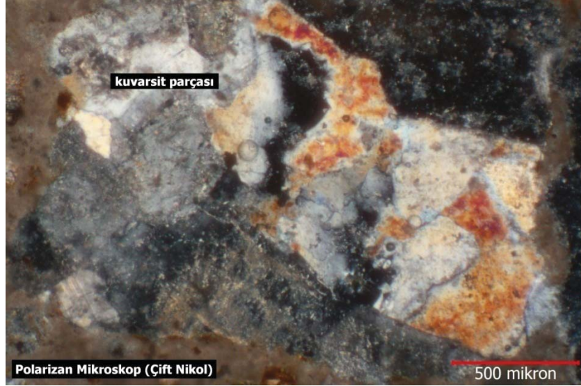
Fotoğraf 3.86. Harç 18'in polarizan mikroskop detay görünümü
