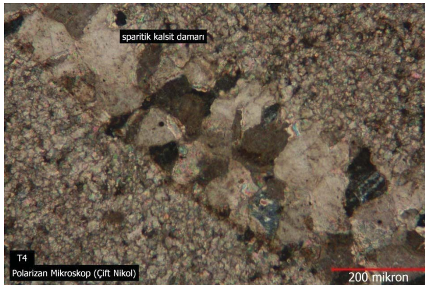
Fotoğraf 3.123. Taş 4'ün polarizan mikroskop detay görünümü
